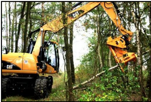
Fällbagger im Einsatz
